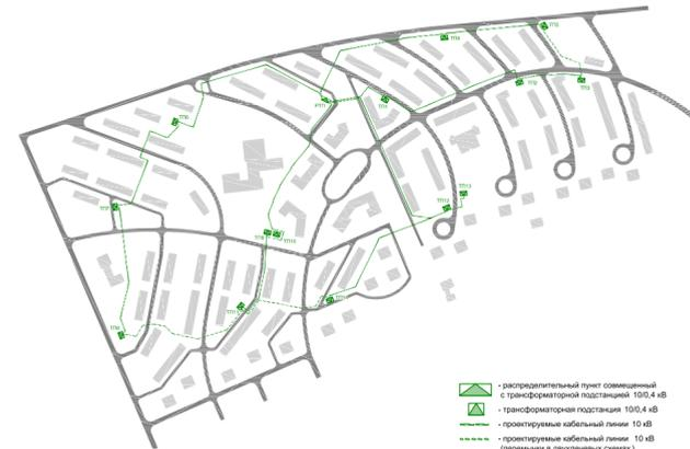
— распределительный пункт совмещенный с трансформаторной подстанцией 10/0,4 кВ
